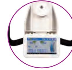
Quilt from the back – Hinteres Bedienelement mit Display und Laserpointer für Pantographarbeiten
